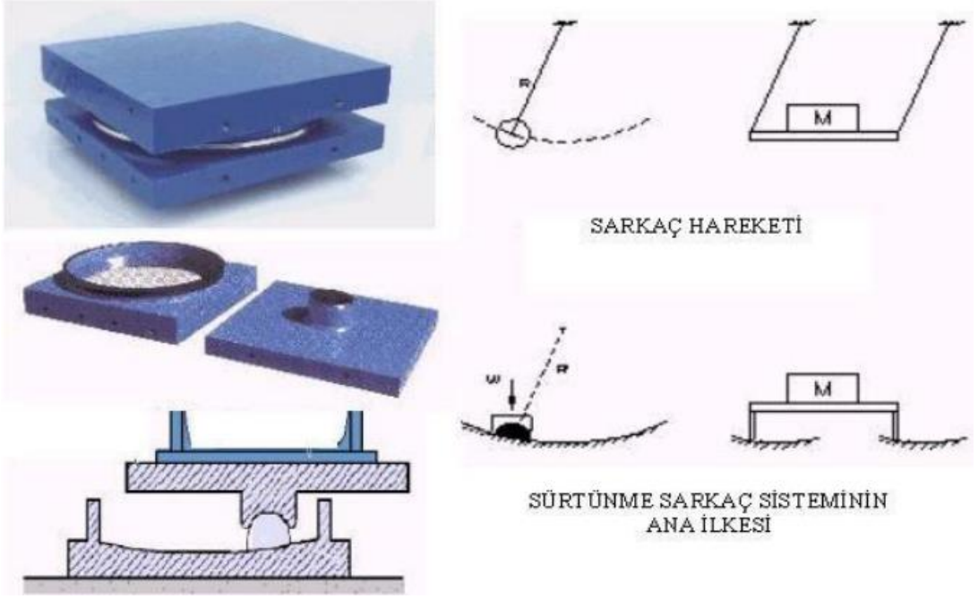
Şekil 2. Sürtülmeli sarkaç sisteminin çalışma prensibi [10]
